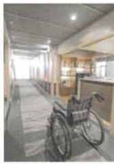
車いす移動が容易となるように引き戸を採用。扉幅や廊下幅も広めにとられています。
